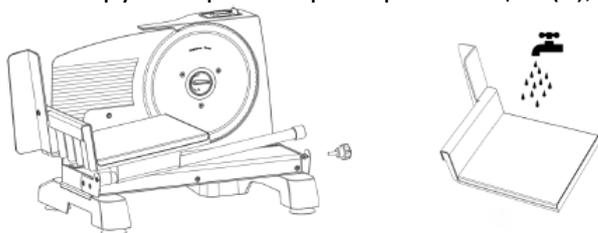
3. Поверните фиксатор ножа по часовой стрелке на 90 градусов и потяните на себя. Снимите нож. Нож можно промыть под проточной водой, затем вытереть насухо и вернуть на место.
